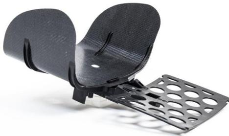
Der Einleger aus Tepex wird in einem Spritzgießwerkzeug mit Wendepatte in einem Prozessschritt umgeformt und mit einem kurzglasfaserverstärkten Polypropylen-Compound hintspritzt, um unter anderem die Tragstruktur für die Kopfstütze und Rückenlehne zu integrieren.
