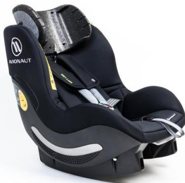
Die als Technologiedemonstrator entwickelte Kopfstütze für den Kindersitz wird im Partikelschaum-Verbund-Spritzgießverfahren gefertigt. Mit dem Einleger aus Tepex kann ihr Gewicht gegenüber der kommerziellen Bauteilvariante um bis zu 30 Prozent gesenkt werden – und das bei vergleichbar guter Crash-Performance.
