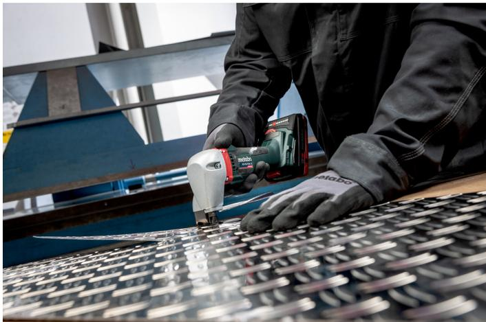
Der Akku-Nibbler ist für die Bearbeitung von Well- und Trapezblech und die Akku-Blechscherer für das Schneiden von flachen Blechen die richtige Wahl. Die Gehäuseschalen und die Ober- und Unterschalen der Akkus beider Werkzeuge bestehen aus Polyamid 6-Werkstoffen Durethan von LANXESS. Fotos: Metabo
