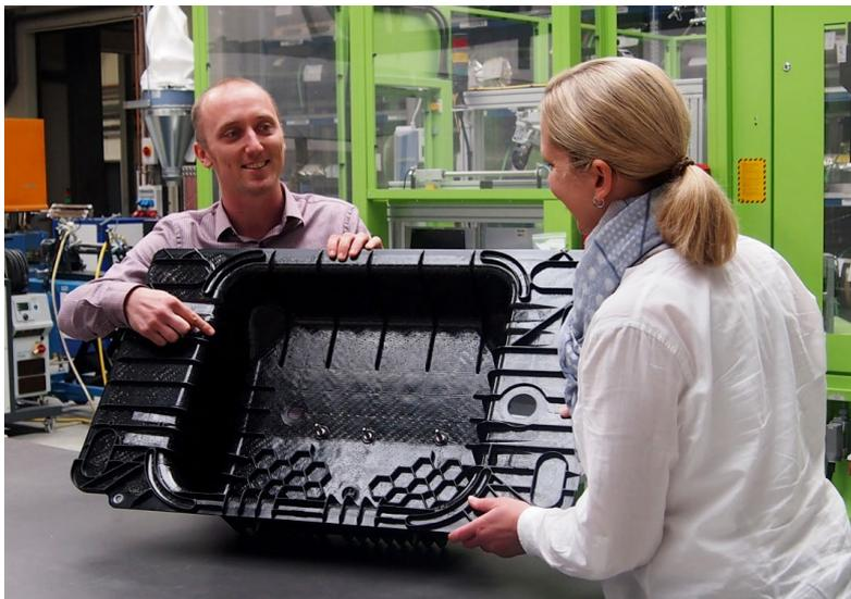
Die Laderaummulde ist mechanisch hochbelastbar und rund 30 Prozent leichter als vergleichbare Ausführungen in Metallblech.
