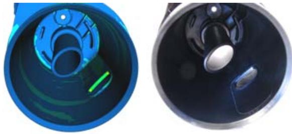
Bild 3 Filtertopf (CAD-Modell und Bauteil)
