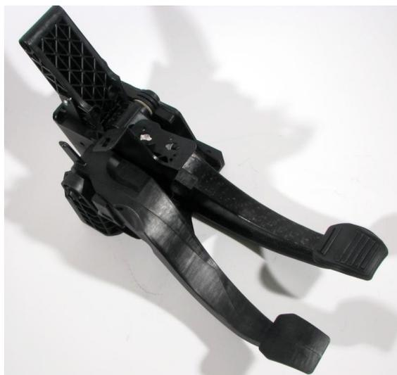
Bild 1 Pedalbock mit Hybrid-Bremspedal und Kuppelungspedal
